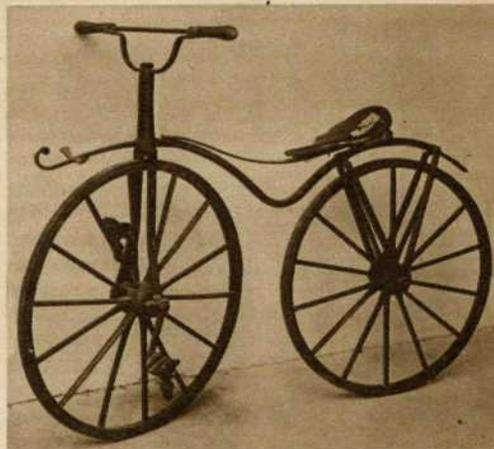
Fahrrad aus dem Jahre 1850 mit Vorderpedal zeigt die zweite Entwicklungsstufe
