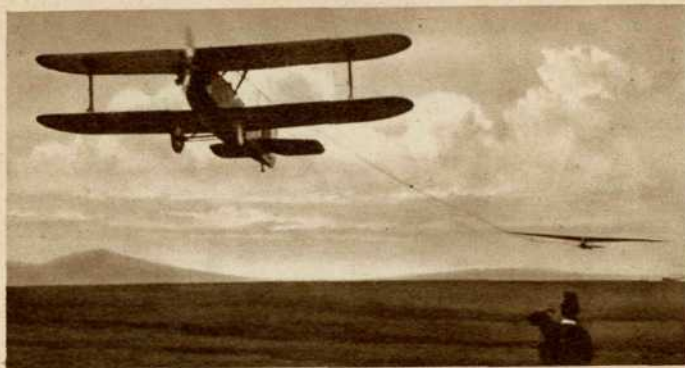
Ein Motorflugzeug schleppt die Segelflugmaschine an einem langen Stahlseil auf große Höhe. Hier klinkt das Segelflugzeug aus zum Beginn des freien Fluges
